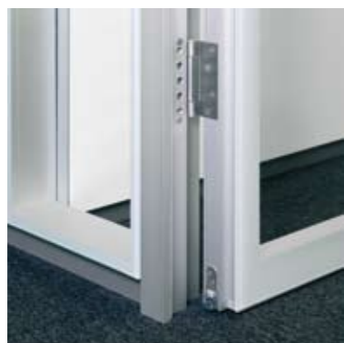
Element: Glas-Türelement fecostruct S60 Türzarge: Aluzarge 18/50 in Alu natur eloxiert für flurseitig flächenbündiges Türblatt Türblatt: Glas-Türblatt fecostruct 60 mm in Alu eloxiert Prüfwert: R_{w,p} = 32 dB, optional 37 dB (doppelverglast) Seitenteil: Verglasung fecostruct in Alu natur eloxiert
