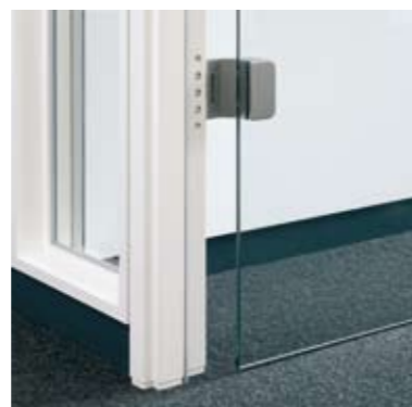
Element: Glas-Türelement G8 Türzarge: Stahlzarge 35/35 pulverbeschichtet weiß Türblatt: Glas-Türblatt 8 mm ESG klar Prüfwert: R_{w,p} = 23 dB, optional 32 dB Oberteil: Verglasung fecoquic pulverbeschichtet weiß Seitenteil: Verglasung fecoquic pulverbeschichtet weiß
