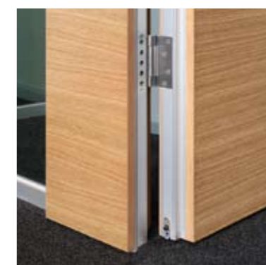
Element: Holz-Türelement H70 flurbündig Türzarge: Aluzarge 18/0 in Alu natur eloxiert, flurseitig verdeckt liegend Türblatt: Holz-Türblatt 70 mm in Eiche natur Prüfwert: R_{w,p} = 32 dB, optional 37 dB oder 40 dB Seitenteil: Vollwand fecowand in Eiche natur
